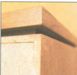
Верхнюю крышку крепят к шкафу через окрашенную в черный цвет прокладку из ДВП. Шурупы заворачивают изнутри шкафа.
